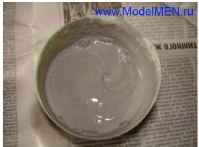
Залейте раствор в форму, следите, чтобы раствор не был слишком жидкий, иначе форма размякнет от воды. Во время заливки немного подымайте форму и постукивайте по столу, чтобы раствор плотно улегся (уплотняйте) по всей форме без пузырей!
