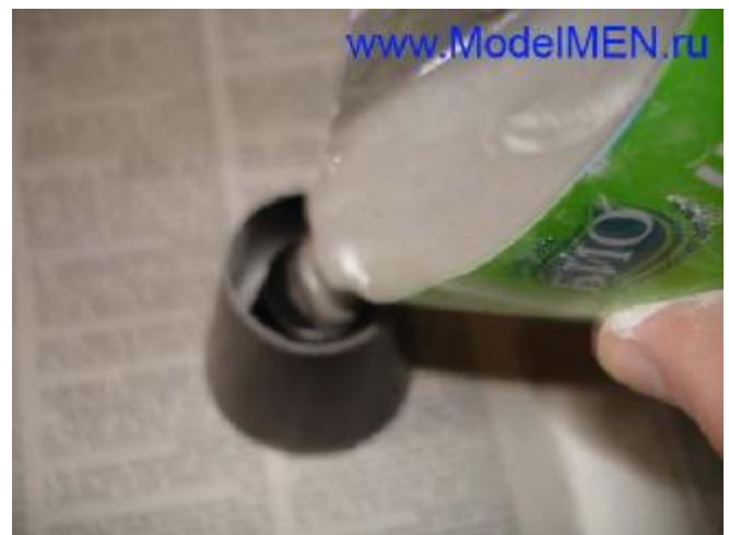
Залейте раствор в форму, следите, чтобы раствор не был слишком жидкий, иначе форма размякнет от воды. Во время заливки немного подымайте форму и постукивайте по столу, чтобы раствор плотно улегся (уплотняйте) по всей форме без пузырей!
