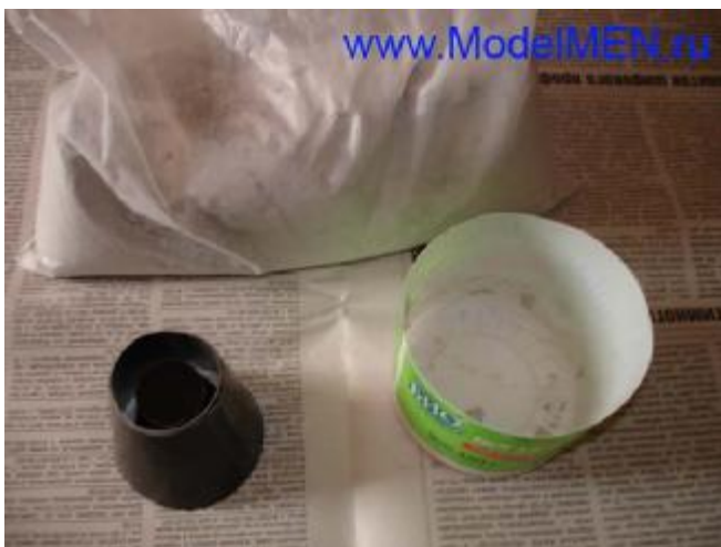
Прикиньте сколько ванн нужно порошка алебаstra и размешайте его водой.
